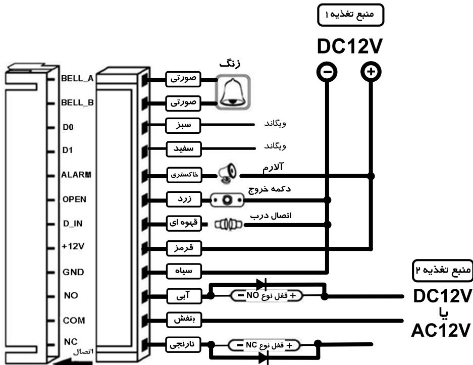
توجه : برای استفاده از قفل هایی که در صورت قطع جریان برق باز می شوند، می توان از NC و COM به جای NO و COM استفاده کرد.
